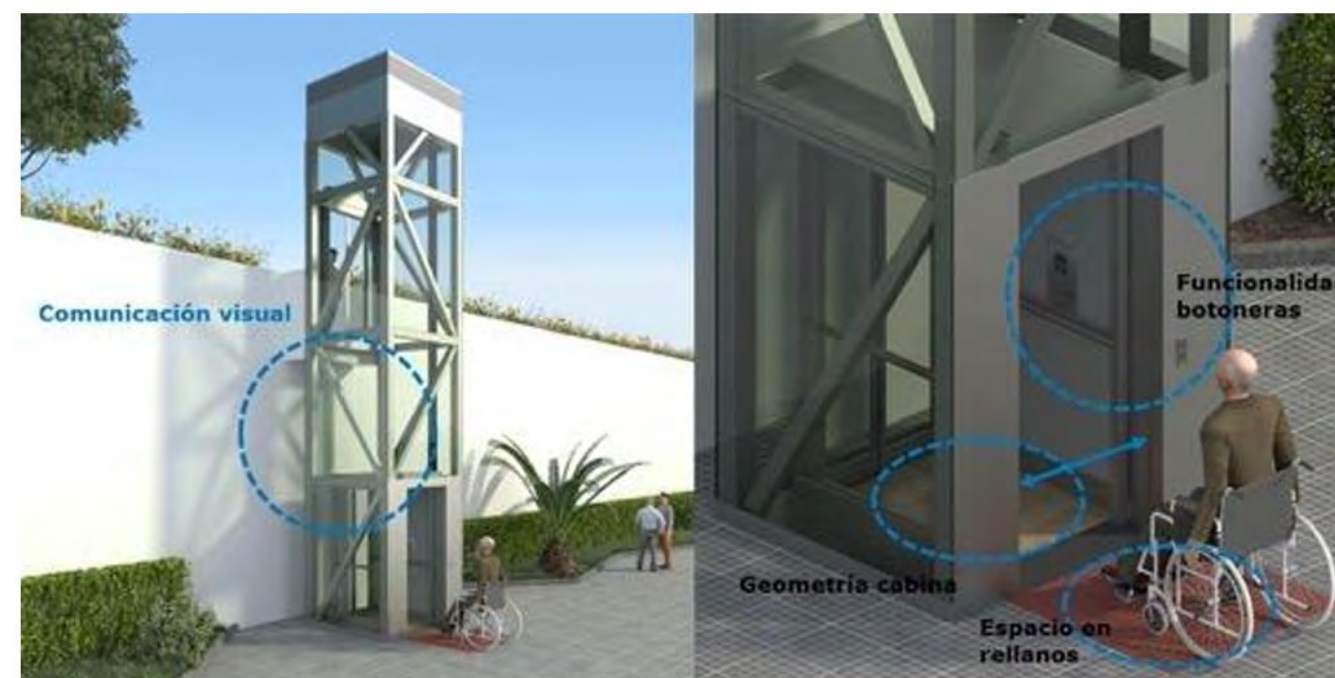
Ilustración 5. Ascensor accesible. Fuente: Manual de accesibilidad para espacios públicos urbanizados del Ayuntamiento de Madrid
